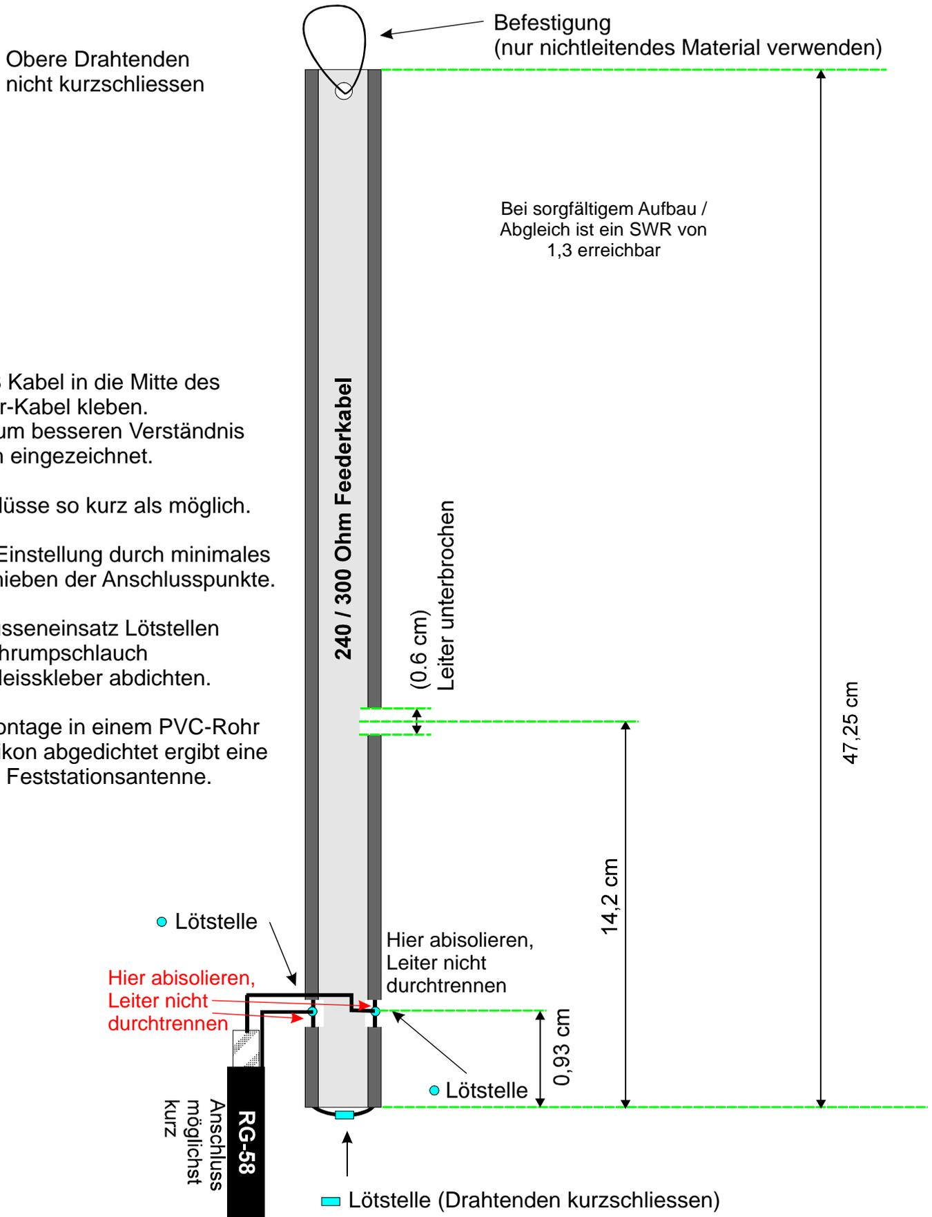
RG-58 Kabel in die Mitte des Feeder-Kabel kleben. Hier zum besseren Verständnis seitlich eingezeichnet.
