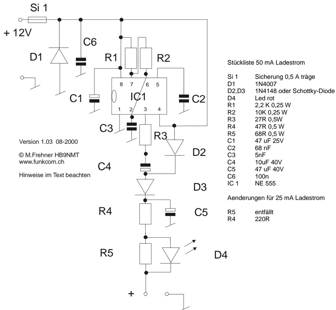
**Achtung:** Die maximale Eingangsspannung beträgt 18V, bei höheren Spannungen wird der IC beschädigt. Für die Elkos sind unbedingt Typen mit der angegebenen Nennspannung zu verwenden (Leerlaufspannungen ! ) Die Schaltung ist gegen falsche Polung der Speisespannung durch D1 und Si 1 geschützt.
